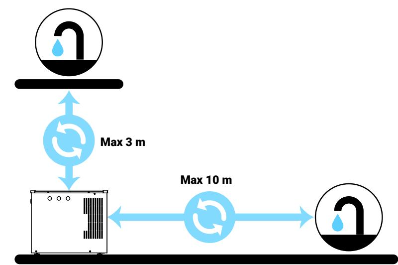
El equipo puede estar separado a una distancia máxima de 10 metros hasta el grifo, o 3 metros en vertical
